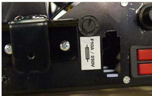
Горелка защищена против сверхтока электрическим предохранителем.
